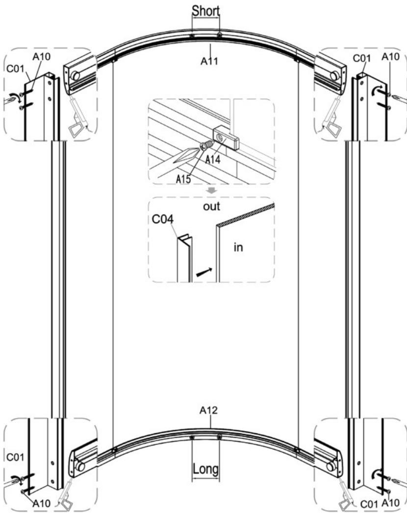
Horní a spodní oblouk spojte se svislými bočními lištami. Montáž provádějte mimo vaničku.
