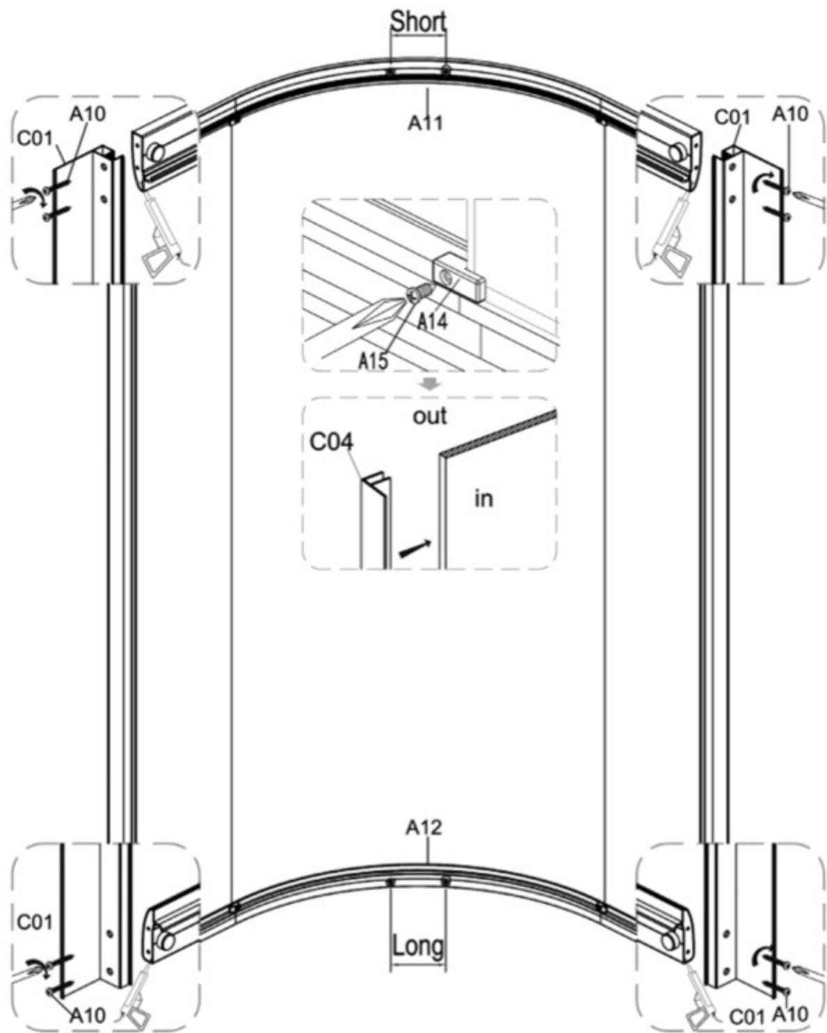
Horní a spodní oblouk spojte se svislými bočními lištami. Montáž provádějte mimo vaničku.
